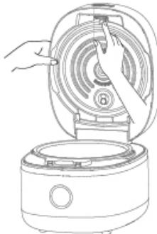
打开煲盖，一只手扶住可拆内盖，另一只手按动内盖按钮，可取下内盖，然后逆时针旋出蒸汽阀帽。
